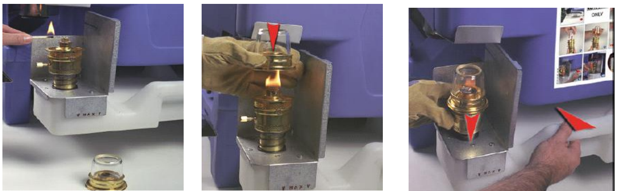
Figure 14 : montage du verre sur le brûleur
